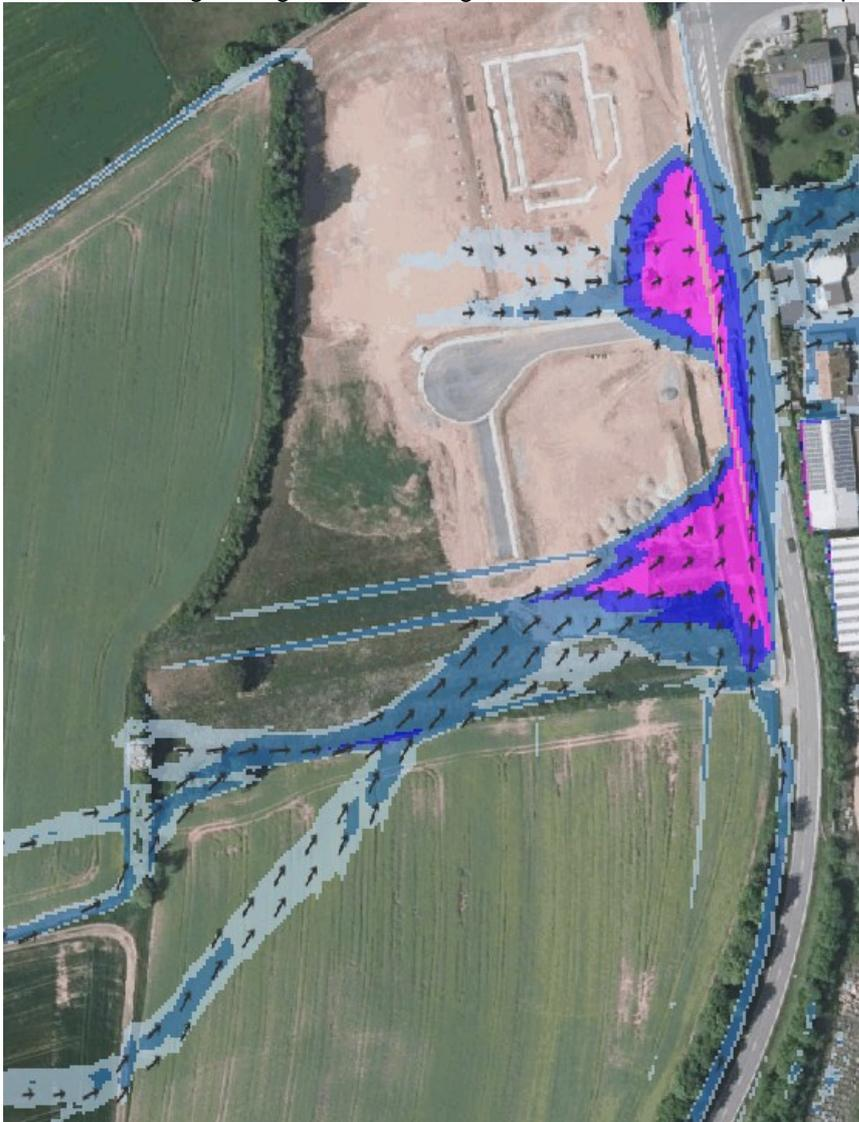
Abbildung 42: Fließrichtungen und Wassertiefen während der Bauphase
