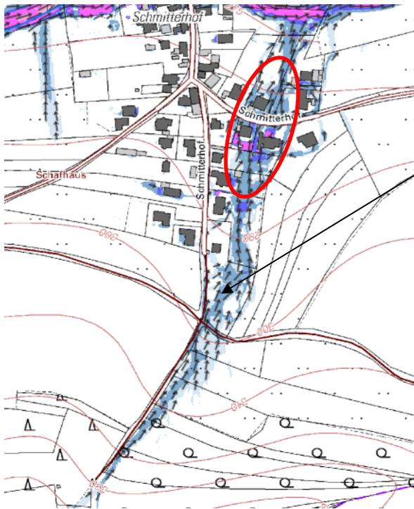
Abbildung 33: Wasserstände und Fließrichtung SRI 7
