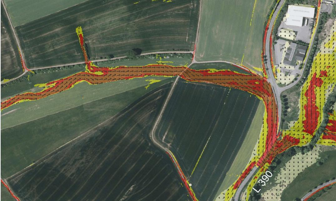
Abbildung 44: Kritischer Bereich L 390 (Fließgeschwindigkeiten und Fließwege)
